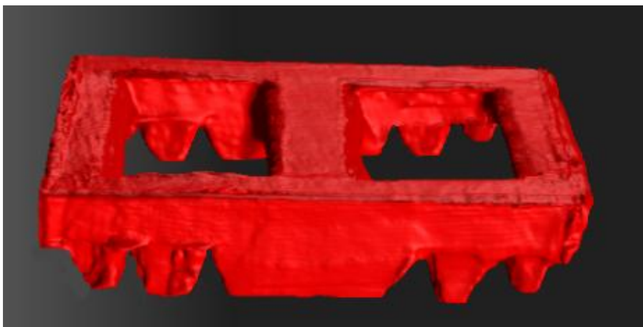
Рисунок 4.13 – Трехмерная модель макета тележки подвижного состава, полученная в результате лазерного сканирования
